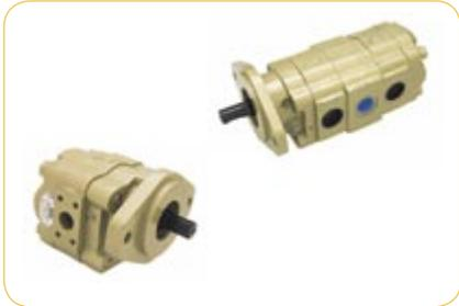
Bombas e motores hidráulicos de engrenagens, corpos de ferro fundido de alta resistência. Mancais de rolamento de agulhas, de elevada capacidade de carga. Para aplicações médias e severas. Podem ser aplicadas como divisores de fluxo/intensificadores de pressão.
